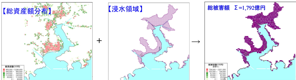
図-2 資産分布と浸水領域から被害総額を算出する手法概要
