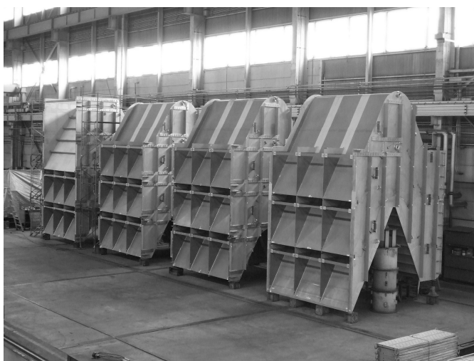
写真-3 工場仮組立状況
