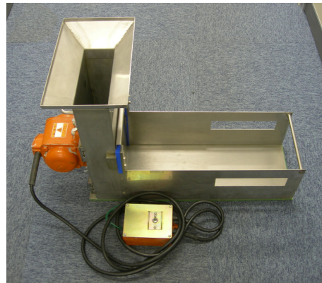
図-1 振動 L 形フロー試験器諸元
