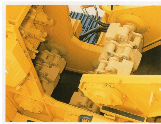
図-2 自走式土質改良機の混合部分状況
