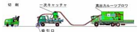
図-1 廃材吸引装置概略図
