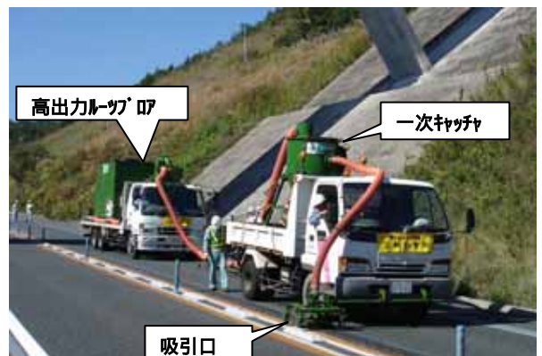
写真-4 廃材吸引装置
