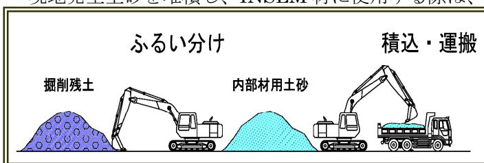
図-10 施工手順(ふるい分け)
