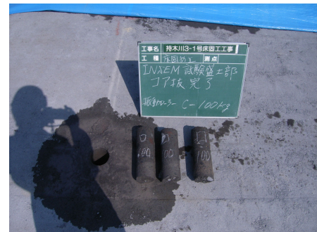
写真-3 INSEM 材のコア抜き
