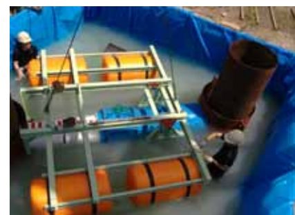
写真-3 伸縮作業性確認状況
