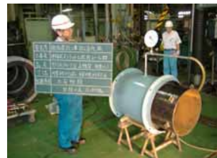
写真-2 止水性確認状況
