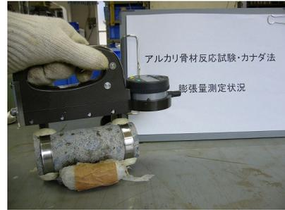
写真-4 膨張量計測状況
