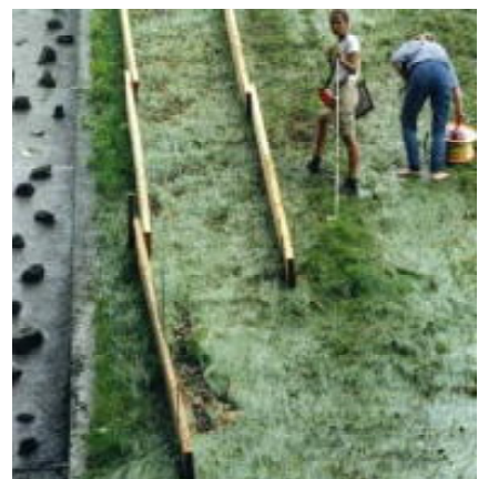
写真-12 耐流速性試験完了
