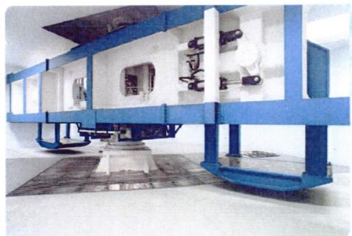
写真2.1 動的遠心載荷装置
