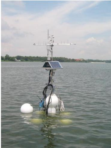
図-3 シンガポール・Kranji貯水池における LDS (貯水内データ収集システム)
