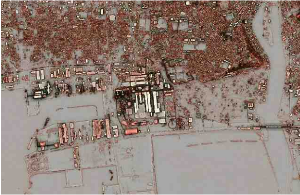
図-1 航空レーザー計測による赤色立体地形図 (石巻地区, アジア航測株式会社作成)
