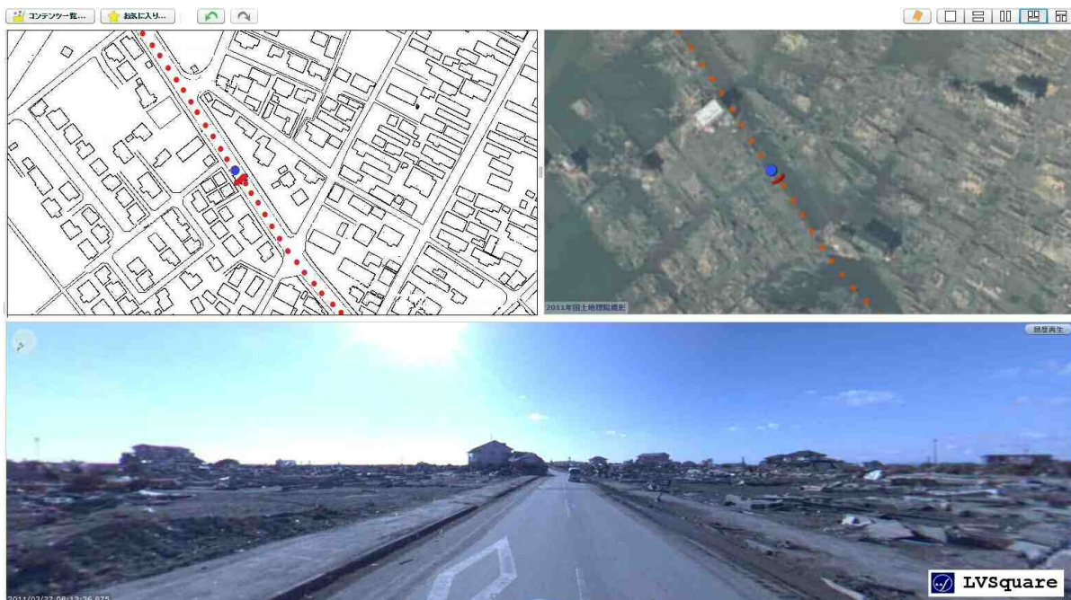
図-4 モービルマッピングシステムによる名取市閑上地区の全周囲パノラマ画像（3月27日アジア航測株式会社撮影、LV Squareにて表示）
