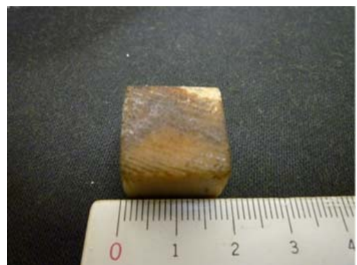
写真-3.1 木材の腐食
