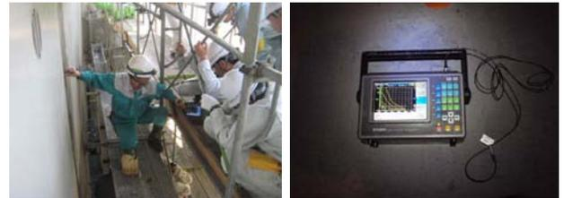
図-17 超音波探傷検査の実施状況
