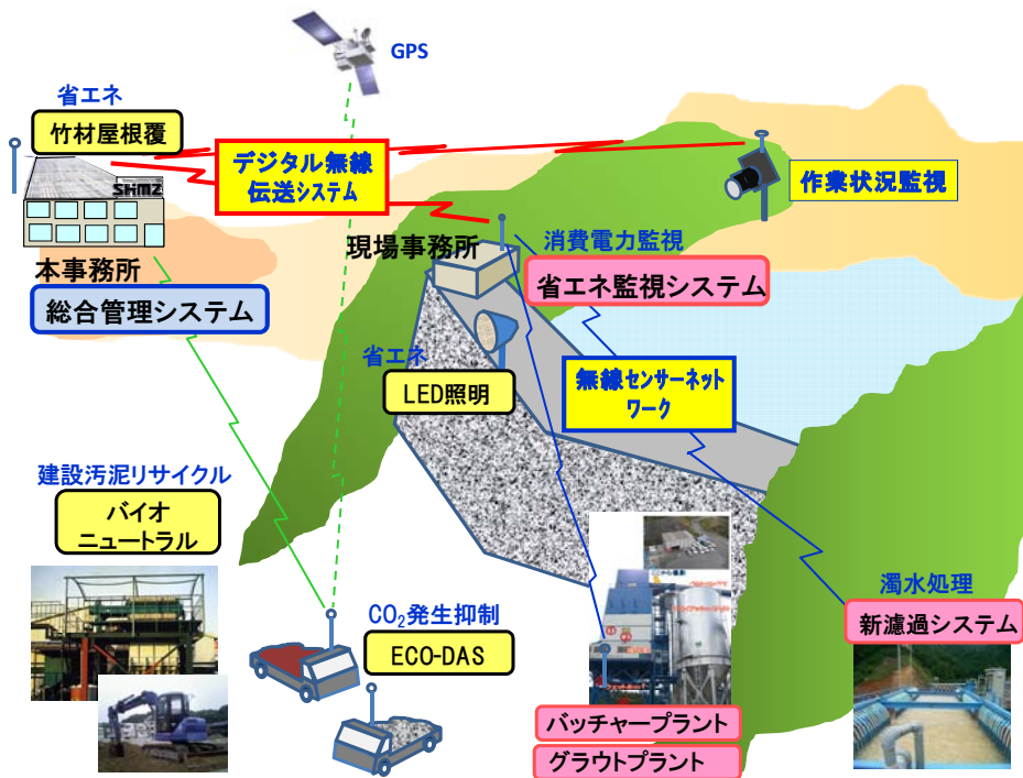
図-6 大津呂ダムでのスマートサイトシステム適用イメージ
