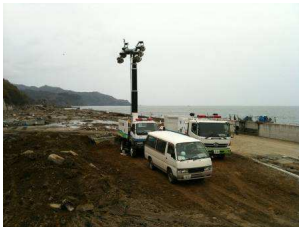
北上川河口部(石巻市)における排水ポンプ車稼働状況
