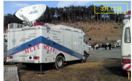
南三陸町に衛星通信車を設営 (近畿整備局TEC-FORCE)
