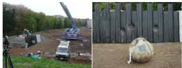
写-4 実物大衝撃試験状況
