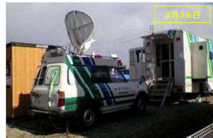
陸前高田市に衛星通信車を設営 (近畿整備局TEC-FORCE)
