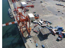
仙台港被害状況調査(気球空撮システムによる調査)コンテナの散乱状況
