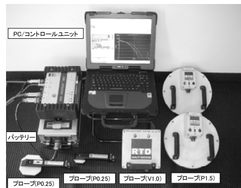
写真-3 INCOTEST の計測機器構成
