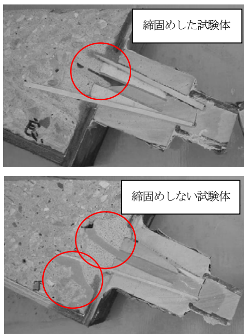
写真-1 PCグラウトの充てん度確認結果
