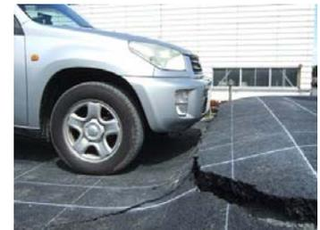
図8 実物大性能確認実験(550mm沈下状況)
