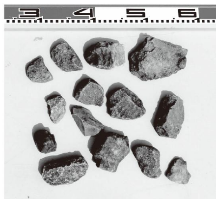
図-7 実験で用いたバラスト (目盛の数字は10cm単位)
