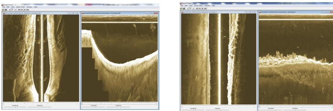
図2 深みの状況 (左図：中央部航路被災箇所、右図：航路海側)
