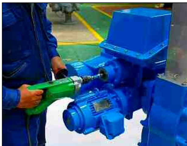
図-8 電動工具による操作状況
