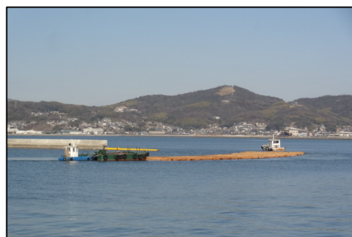
図-10 荷下ろした原木で組んだ筏による水面貯木場への運搬状況
