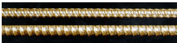
写真-2 アラミド FRP ロッド (異径ロッドタイプ)
