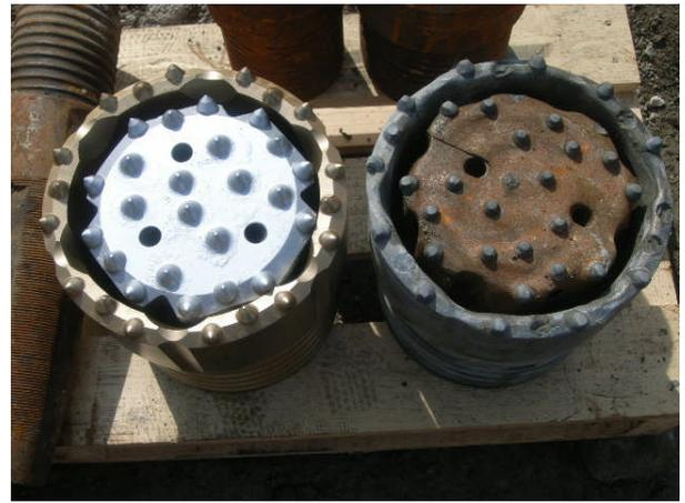
図-2 ビット損耗状況
