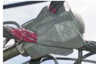
写真2.4 試験後のクロスクリップ状況
