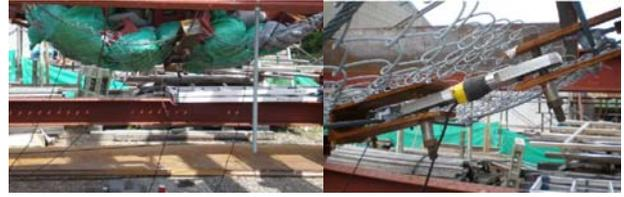
写真2.2 変位計設置(左)、ロードセル(右)
