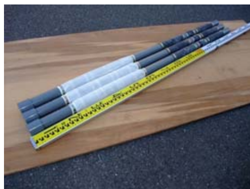
写真-2 注入外管
