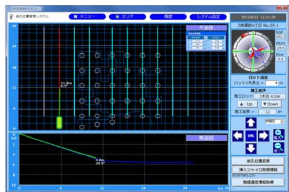
写真-4 曲り削孔管理モニター
