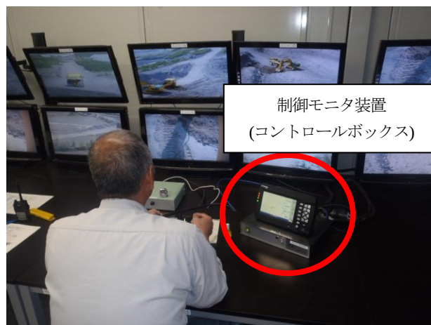
写真-2 MG施工状況
