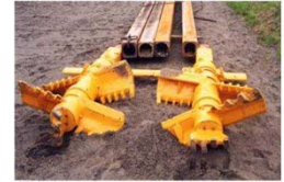
従来の機械攪拌工法で使用する攪拌翼 (DJM工法φ1.0mの場合1.0mで固定)
