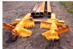
従来の機械攪拌工法で使用する攪拌翼 (DJM工法φ1.0mの場合1.0mで固定)
