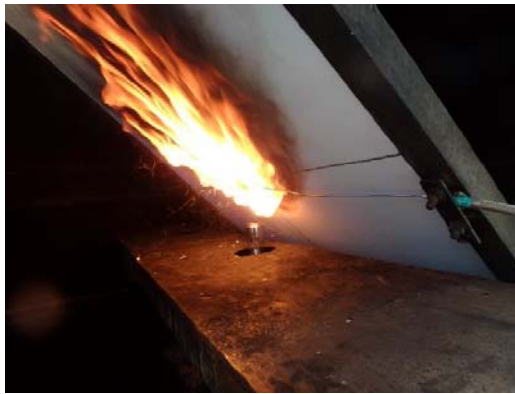
写真5 延焼性試験の状況
