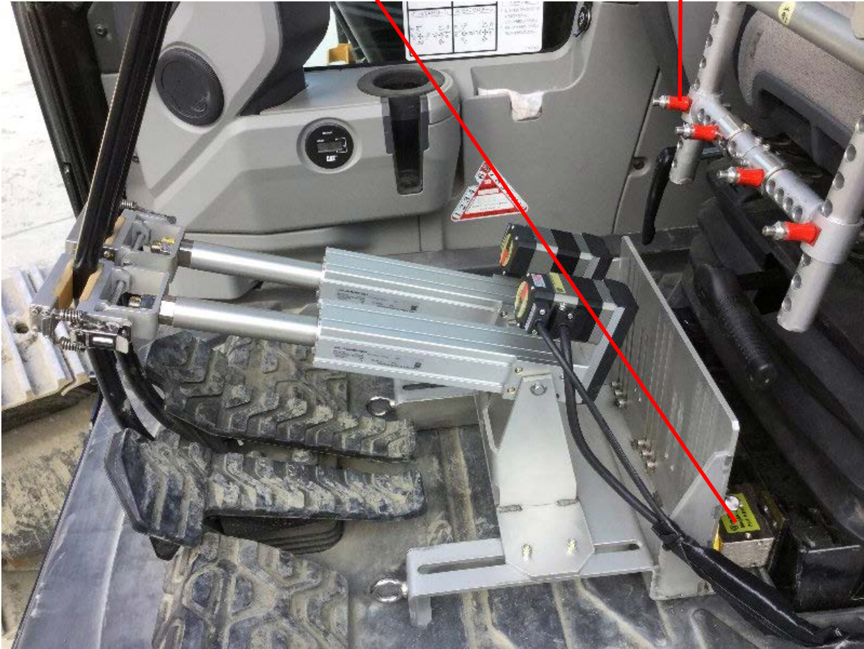
走行ユニット
