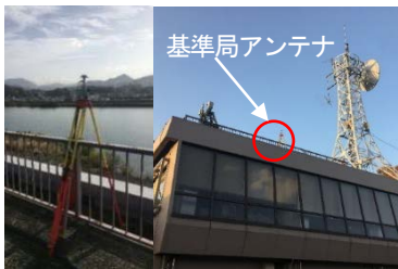
図-5 基準局の設置状況
