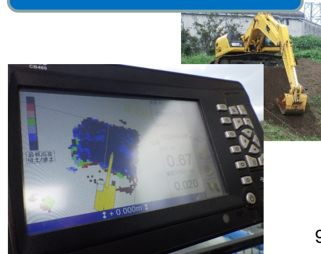
IC建機の施工履歴データ
