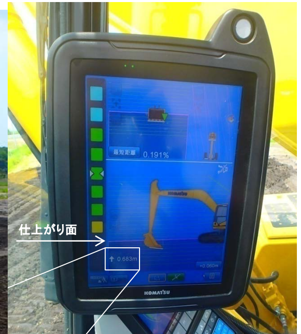
【ICT建機のバックホウの液晶画面】 画面に施工目標と自機の状態表示を行っている。
