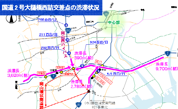
図-1 国道2号大樋橋西詰交差点の渋滞
