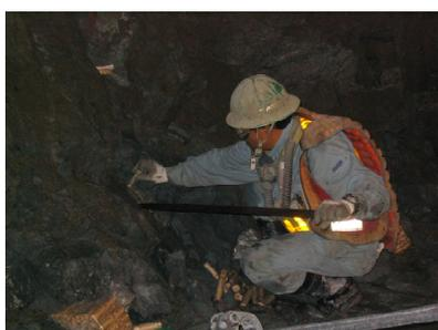
写真-1 爆薬の装填状況
