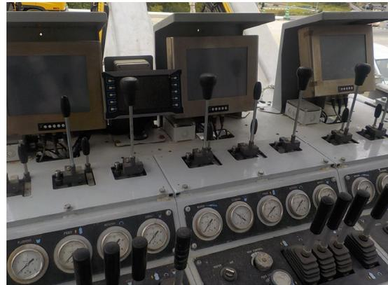
写真-8 電磁バルブ化した搭乗用の運転席
