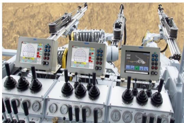
写真-5 運転席に配置したマシンガイダンスモニター
