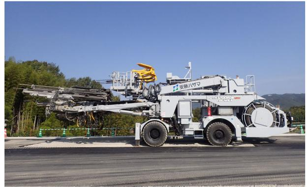
写真-10 遠隔改造 MG ジャンボ
