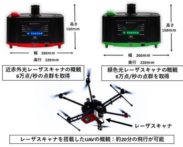
図-13 UAVレーザ測量による地表面形状取得例
