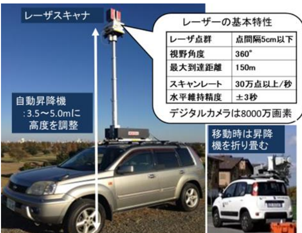
図-15 車両移動型レーザ測量技術の概要
