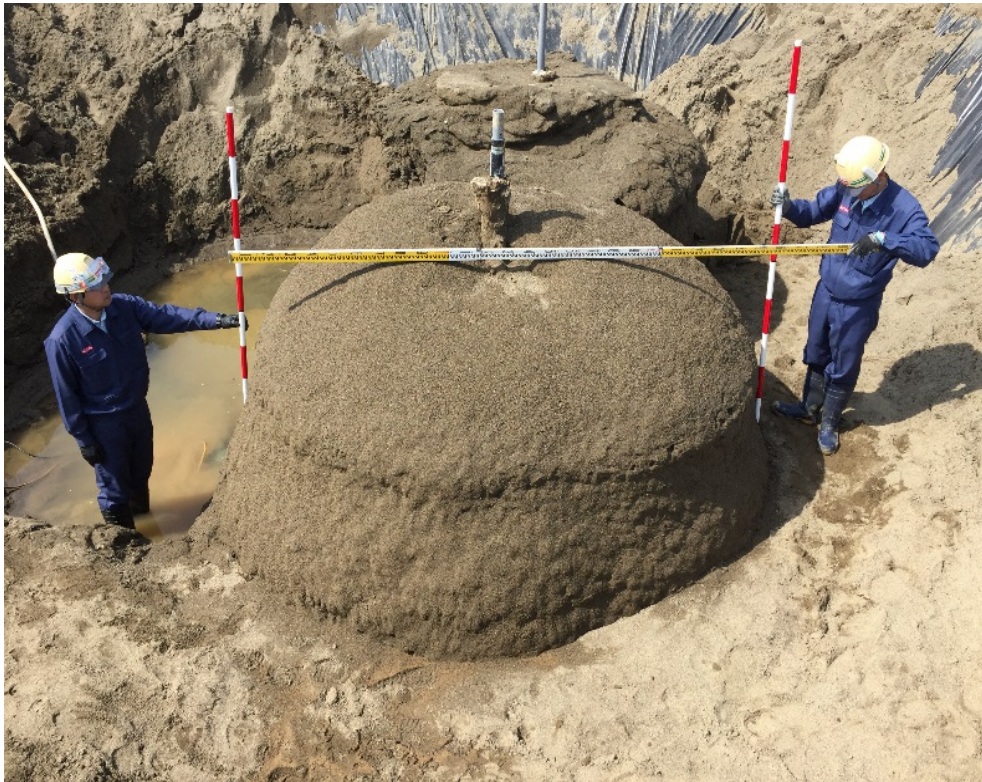
計画改良体径 \phi 2500 18L/min
