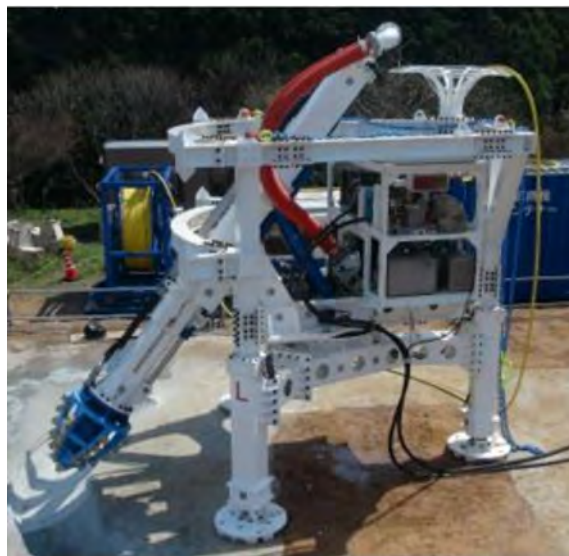
硬質地盤対応水中掘削機
