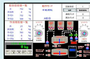
プラントモニター
