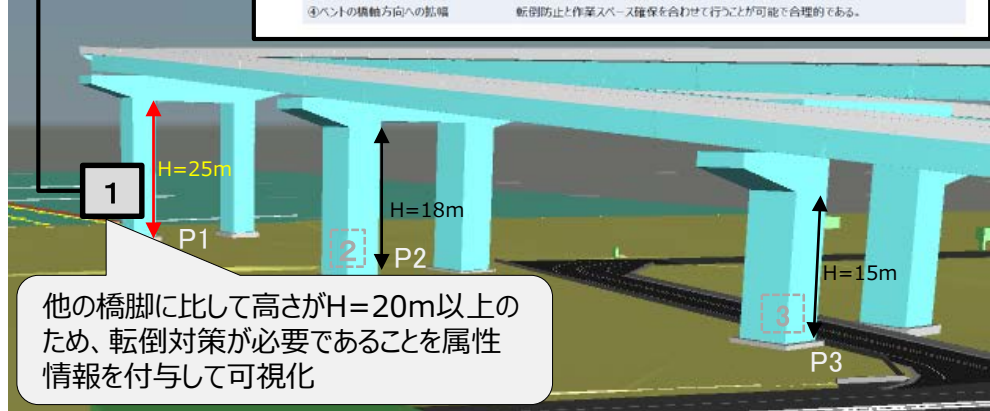
2) 安全対策を施すべき箇所の可視化 (属性情報に付与することで留意点を可視化するパターン)
