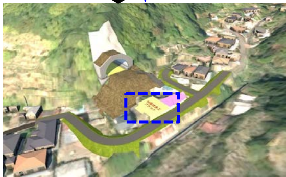
2) 橋台の施工に備え、地盤改良を実施
