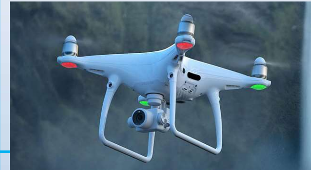
ICT活用 UAV写真測量
