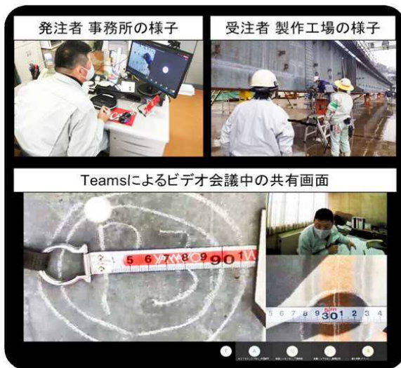
図-4 遠隔臨場時の状況概要図（発注者による確認状況）
