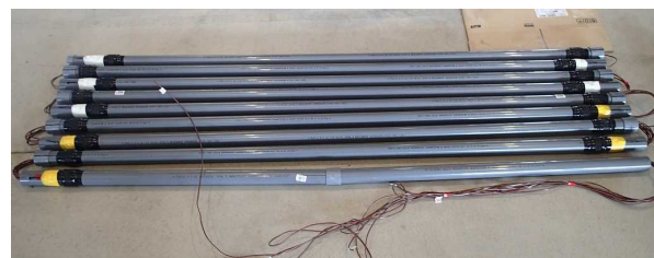
写真-3 測定管の製作状況 (2m×9本=18m)
