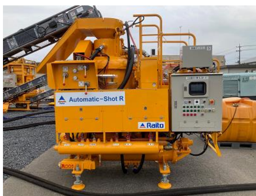
写真-3 全自動吹付機 (RLSW-AT)
