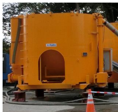
写真-7 9t減算計量式セメントサイロ
