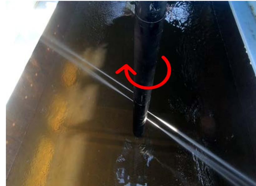
超高圧噴流水のまわりに**空気を沿わせる**ことにより、**切削距離を大幅に伸ばす**ことができます。
