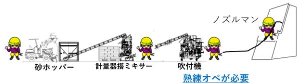
図-4 従来型方式吹付プラント人員配置
