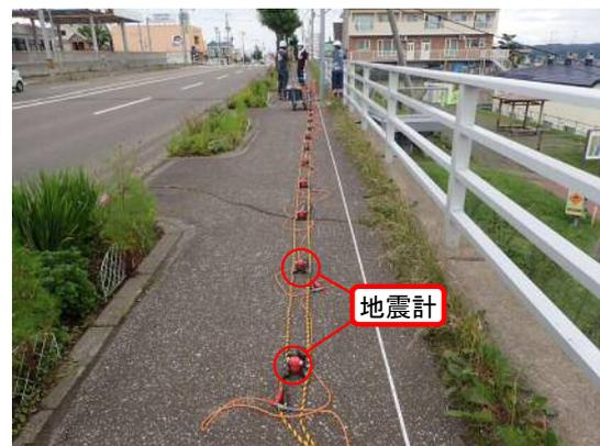
写真-1 補強土壁での表面波探査の測線の例
